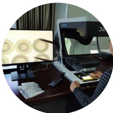
sistema di ispezione 3D come DRV-Z1. Il sistema ideale per questa applicazione, in quanto offre sia l'accuratezza che l'efficienza nel processo di controllo.
